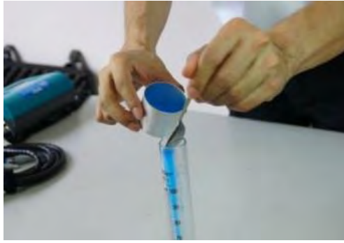
รูปที่ 9 การเติมสารละลายคอปเปอร์ซัลเฟต
