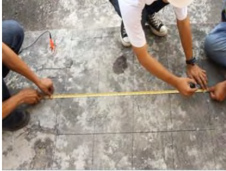
รูปที่ 12 การตีกริดบนที่แต่ละตำแหน่งทดสอบ
