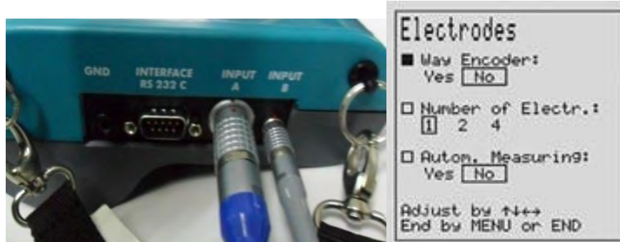
รูปที่ 26 การต่อสายไฟฟ้าที่เชื่อมต่อกับเหล็กเสริมกับเครื่องทดสอบ
