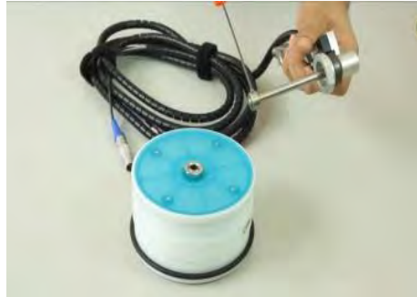
รูปที่ 23 การต่อ Wheel electrode กับก้านต่อ
