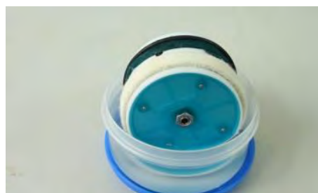
รูปที่ 25 การวางอิเล็กโตรดในภาชนะน้ำกลั่น
