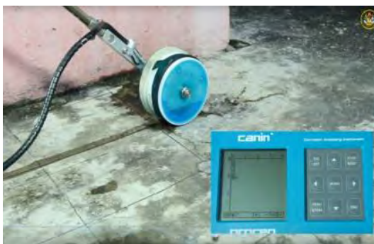
รูปที่ 28 การเลื่อนล้อทดสอบ
