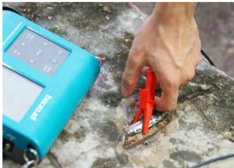
รูปที่ 13 การเจาะสกัดผิวคอนกรีตให้สามารถเชื่อมต่อกับเครื่องทดสอบได้
