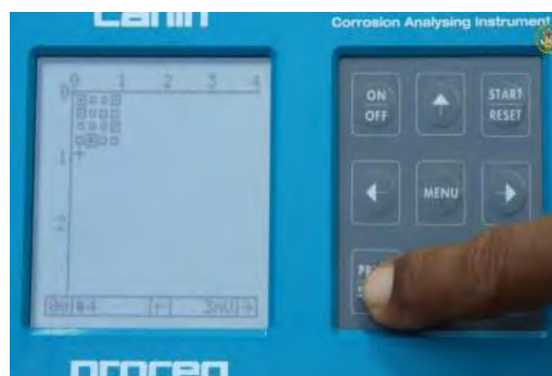
รูปที่ 22 การกดปุ่ม Store และกดปุ่ม END เมื่อทดสอบครบหมดทุกจุด
