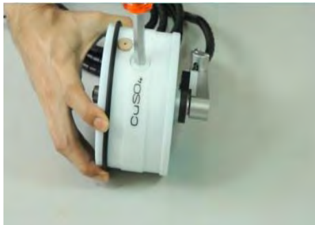
รูปที่ 24 การเติมน้ำลงในช่อง H_2O จนเต็มและปิดสกรูกลับเข้าไป
