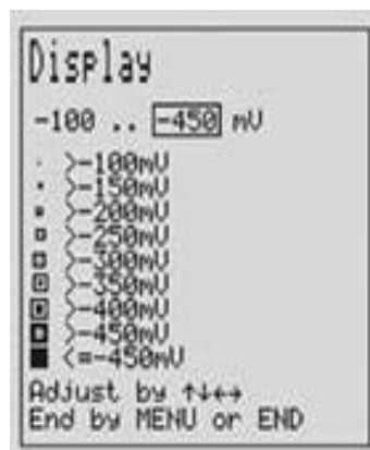
รูปที่ 16 การตั้งค่าการแสดงผลความต่างศักย์ให้เป็นระดับสีต่างๆ
