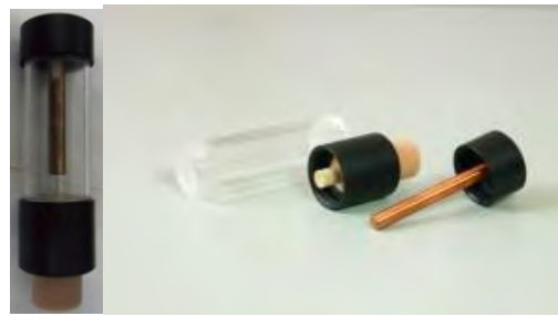
(2) ตัววัดแบบ Rod Electrode
