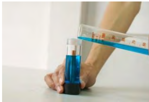
รูปที่ 10 การเติมสารละลายคอปเปอร์ซัลเฟต
